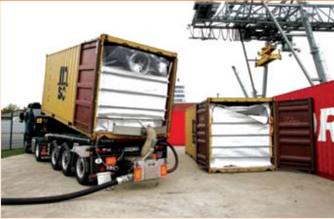
Schließlich werden am Standort Bonn Container-Transportfahrzeuge mit spezieller technischer Ausrüstung wie Kippvorrichtung, Kompressor und Zellenradschleuse vorgehalten
